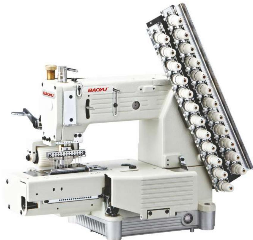
**Двенадцатиигольная швейная машина цепного стежка с задним роликом и цилиндрической рукавной платформой, для пришивания поясов.**
