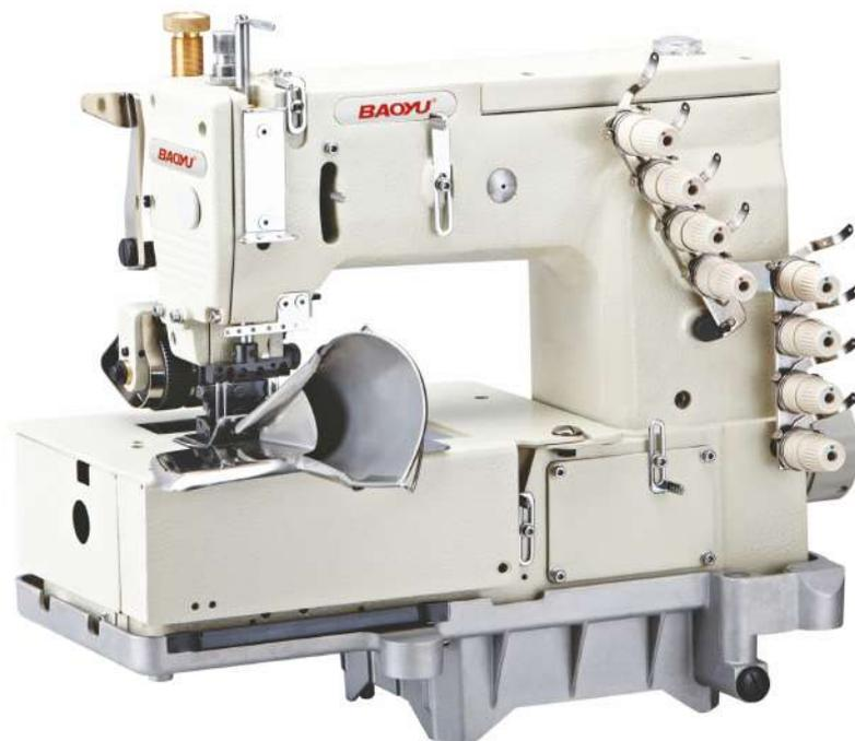
**Четырехигольная расширяющая швейная машина для притачивания
