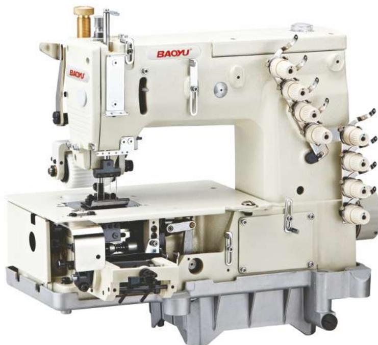
**Четырехигольная промышленная машина цепного стежка с задним роликом, для гафрирования поясов.**
