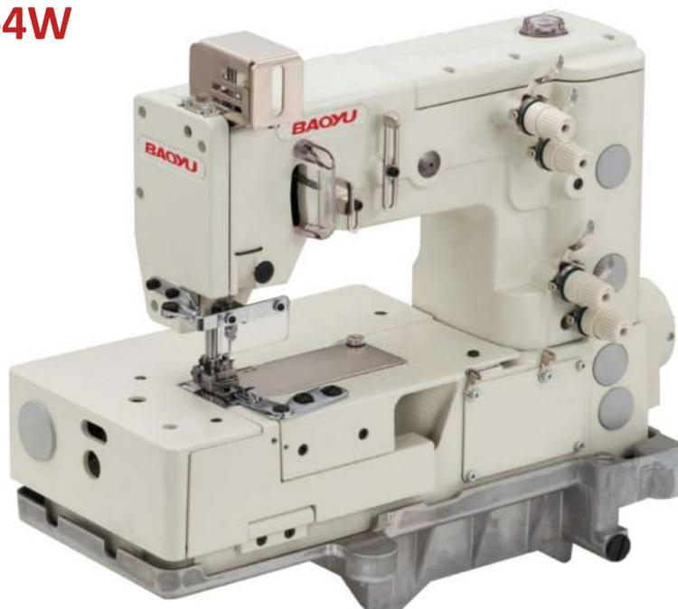
**Двухигольная машина двухниточного цепного стежка пятикольного декоративного зиг-зага. Предназначена для декоративной обработки края, плоскости или соединения двух деталей строчкой типа «крошет».**
