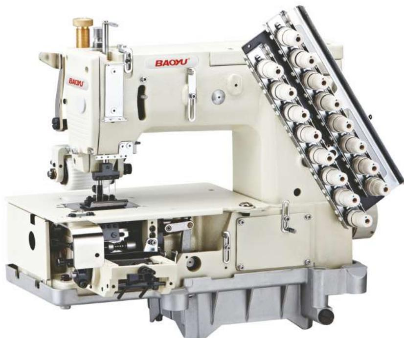
**Восьмигольная машина двухниточного цепного стежка с плоской платформой и вертикальным перемещением петлителей для притачивания лампасов (Adidas). С задним тянущим роликом.**
