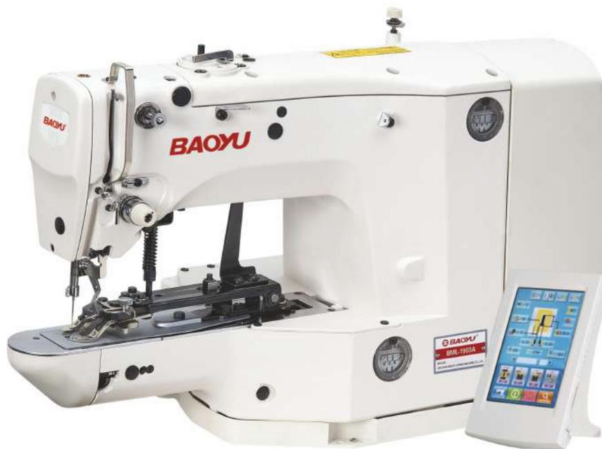
**Компьютерная пуговичная машинка 4 в 1 с прямым приводом (все виды пуговиц, минус закрепка, D закрепка, круглая втулка на кепку) С электронным сенсорным управлением (панель управления на трех языках Турецкий, Английский, Китайский).**
