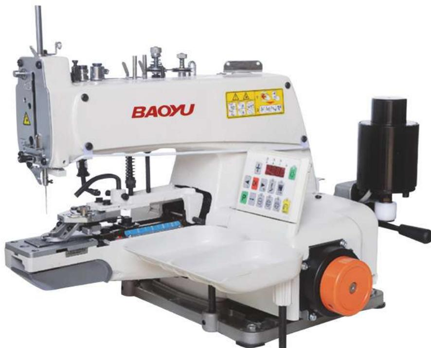
**Автоматическая машина для пришивания круглых плоских пуговиц (с тройным видом стежка) и пуговиц на ножке (при установке специального приспособления) автоматическая обрезка нити и подъем лапки.**
