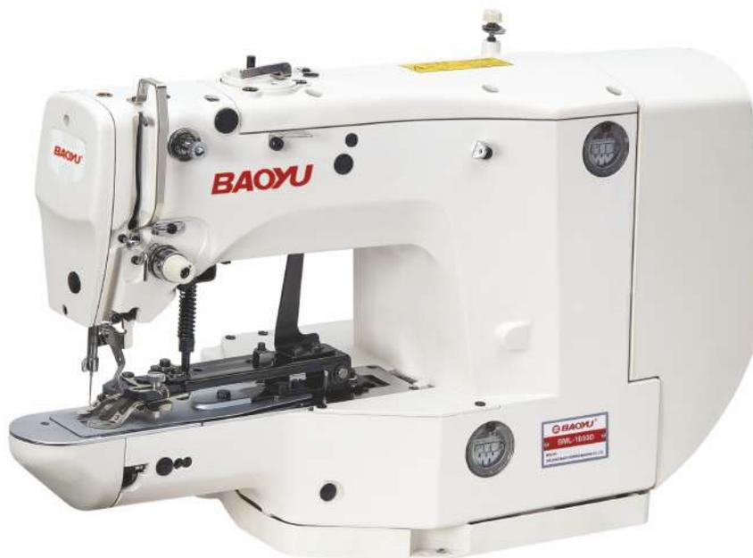
**Электромеханическая закрепочная швейная машина с рабочим полем 16x3 мм, для средних материалов.**
