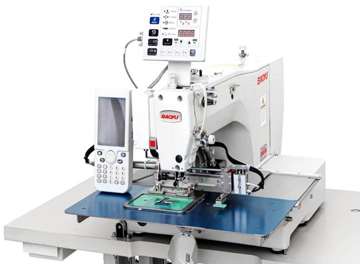
Система игл – DPx5. Рабочее поле – 130 x 100 мм. Машина укомплектована пневматической откидной прижимной рамкой для шитья ярлыков, липучек, этикеток и других мелких деталей. Доступна опция отключения рамки.
