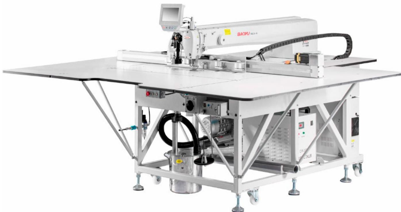
Машина оснащена высокоточной механикой, пневматическим приводом и компьютерной панелью управления. Сенсорная панель управления представлена большим LCD-экраном с английским интерфейсом. Доступны следующие опции: автоматическая обрезка нити, нитеотводчик и подъем лапки. Максимальная скорость работы швейной машины — 3 500 ст/мин. Серводвигатель обеспечивает практически бесшумную работу и отсутствие вибраций.
