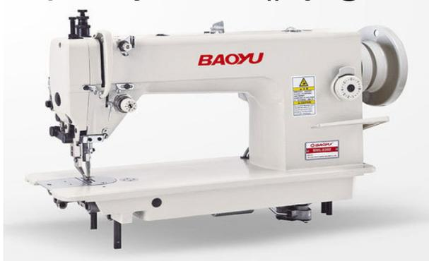
Машина Ваоуи 0302 предназначена для стачивания средних и тяжёлых тканей, кожзаменителя, кожи и других трудно — транспортируемых материалов. В машине применён челнок увеличенного объёма и механизм поспосадочного перемещения материала, который полностью исключает смещение слоев ткани при шитье. Машина имеет систему автоматической смазки и большую высоту подъема лапки.
