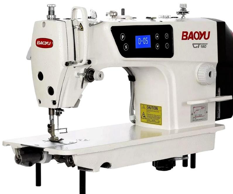
Расположение панели управления позволяет оператору вносить необходимые настройки непосредственно при работе. Сервомотор тайваньского производителя Ho-Hsing обладает энергоэффективностью и обеспечивает практически бесшумный процесс шитья. Система смазки Ваоу GT180H — открытый масляный картером с одним автоматическим масляным насосом.
