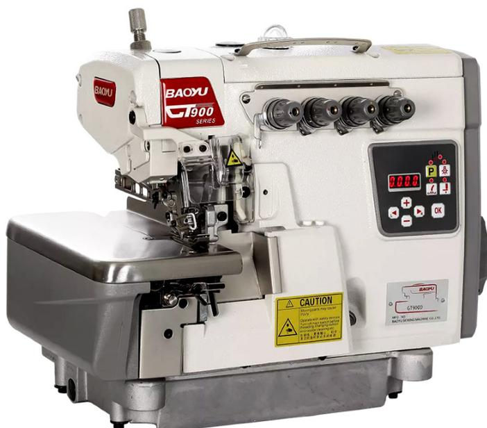
Панель управления разработана тайваньскими инженерами. Она гармонично вписана в корпус оверлока, удобна в управлении и имеет простой интерфейс. Пульт управления находится в хорошей зоне видимости для оператора, режимы удобно переключать во время работы краеобметочной машины. Доступны следующие функции: позиционирования иглы, плавного старта, задания лимитов скорости шитья и интегрированная LED-подсветка.
