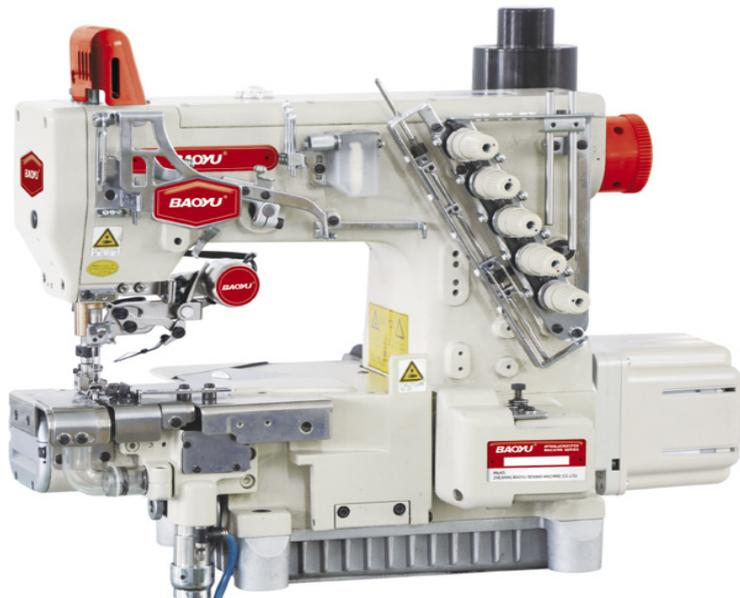
**BML-787-N600-AST-DS/H (ADA)** - промышленная распошивальная машина с цилиндрической рукавной платформой, встроенным сервомотором и левосторонним ножом для обрезки излишек ткани. Остатки обрезки отводятся с помощью вакуумного отсоса. Распошив также снабжен направляющими полиуретановыми роликами и автоматической обрезкой верхней и нижней нити. Данная модель применяется для получения ровного края при подвороте низа изделия.
