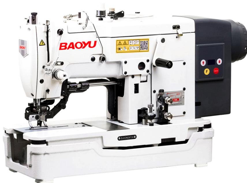
Петельная машина оснащена японским челноком высшего качества и автоматической системой смазки. Предусмотрены автоматические функции: подъем лапки и обрезка. Максимальная скорость шитья — 4000 ст/мин. Максимальная длина петли — 31.8 мм. Максимальная ширина — 5 мм.
