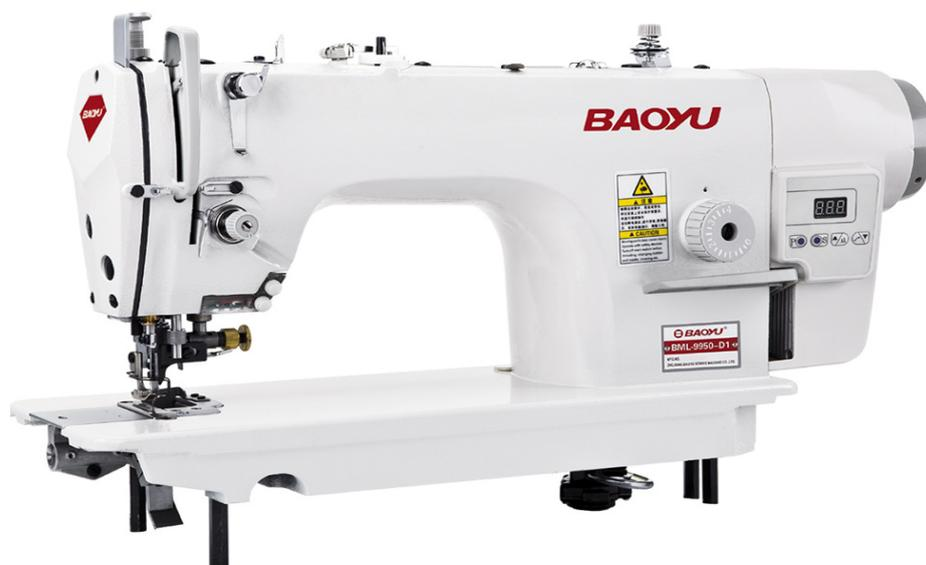
BML-9950D - промышленная швейная машина с устройством обрезки края материала. Модель данного класса предназначена для стачивания встык и подготовки края под окантовку. Ширина обрезки ножа гибко изменяется с помощью предусмотренного механического регулятора. В рабочей платформе также расположена выемка для отвода остатков обрезки.
