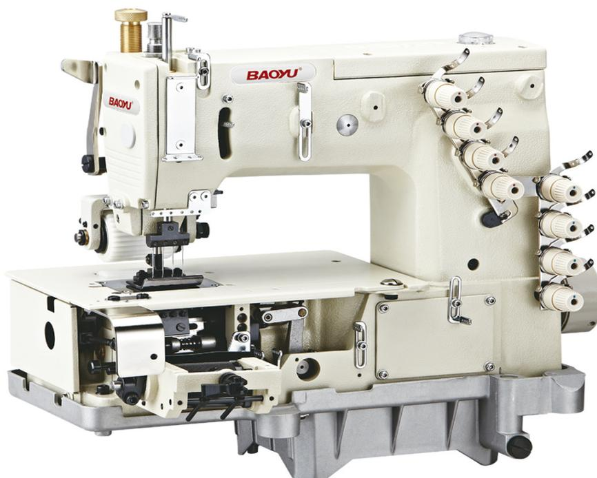
BML-1404PMD - четырехигольная восьминиточная швейная машина цепного стежка с фронтальным механическим устройством равномерной подачи эластичной резинки. Резинка подается посредством пары роликов. Сила давления роликов регулируется. Оборудование данного класса применяется для пришивания резинки к текстильным изделиям. Широко используется при пошиве нижнего белья, спортивной одежды, женской одежды и предметов интерьера.
